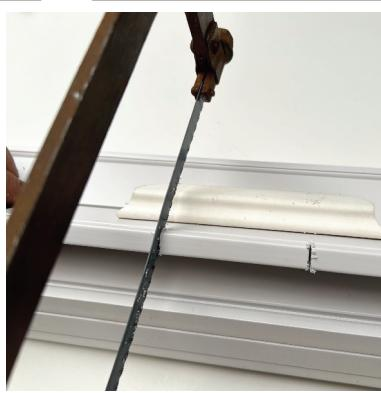
Haga el corte de 8 cm x 8 mm, sin sobrepasar la línea del soporte del mango con la cuchilla. Véase la figura. 9
