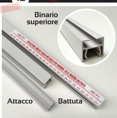
Cortar las 2 ménsulas y el tope de altura a medida con el adhesivo métrico. El riel superior de 2 mm menos que la medida medida, ver fig. 3.
