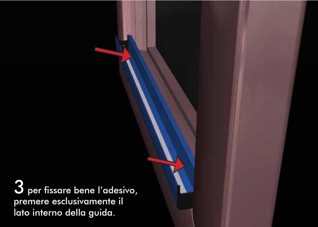
**3** per fissare bene l'adesivo, premere esclusivamente il lato interno della guida.
