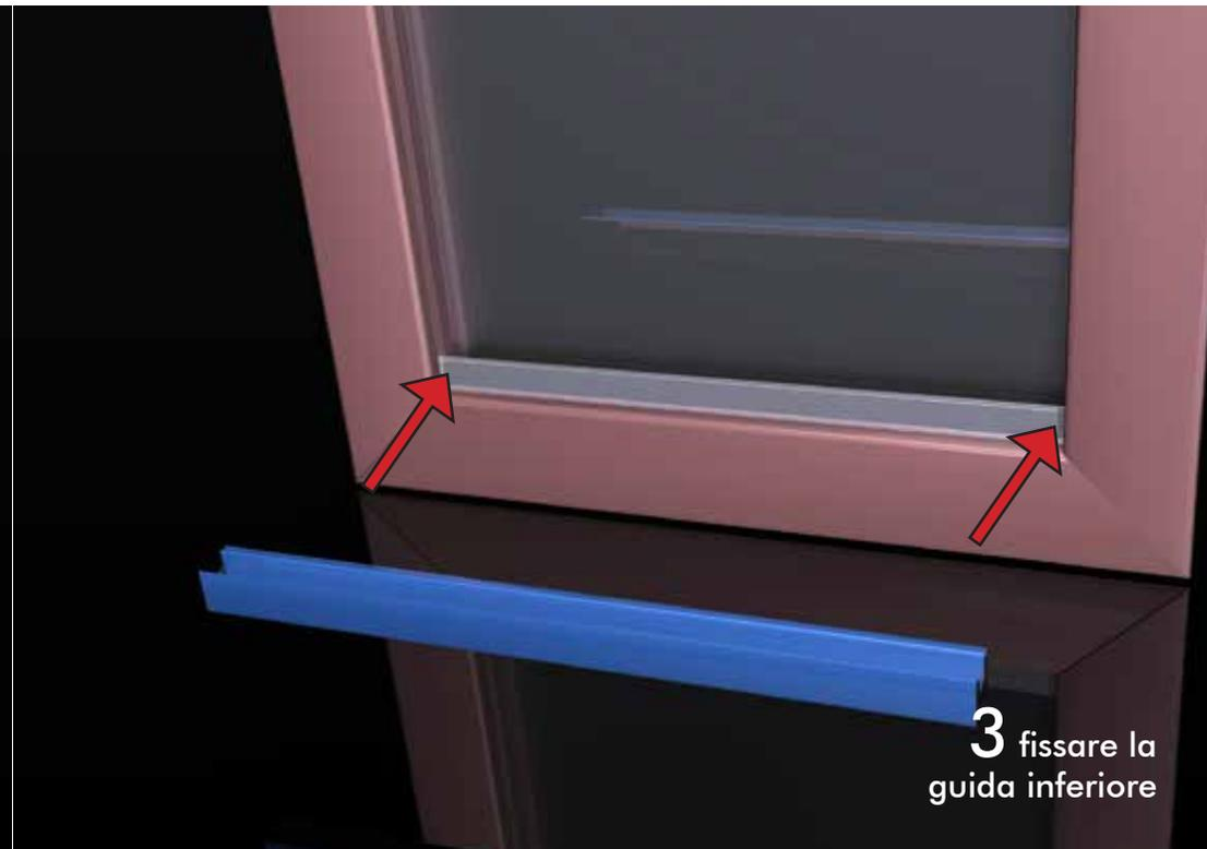
**3** fissare la guida inferiore
