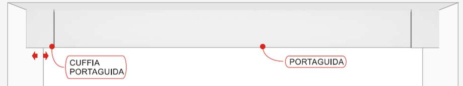
**2** Inserire il profilo laterale (lato cassonetto) nella cuffia portaguida superiore e fissarlo al vano. Ripetere l'operazione sul lato opposto utilizzando il profilo con magneti.
