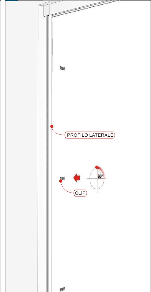
**4** Posizionare l'accessorio guida montaggio piattina nella parte bassa del vano all'interno dei profili laterali.
