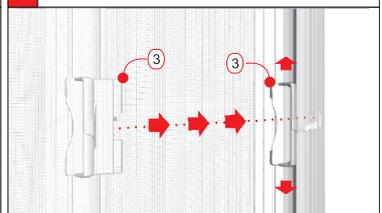
**C** Inserire l'apposito accessorio (4) nel canale guida posizionandolo sulla parte superiore della maniglia(3) ruotandolo per bloccarlo.
