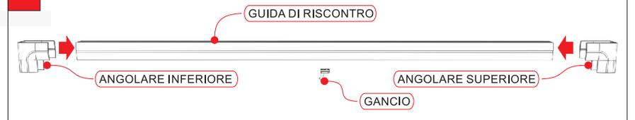
**5** Inserire la guida superiore nell'innesto della controtestata e fissarla usando l'accessorio interno guida. Fissare la guida di riscontro nella parte alta.
