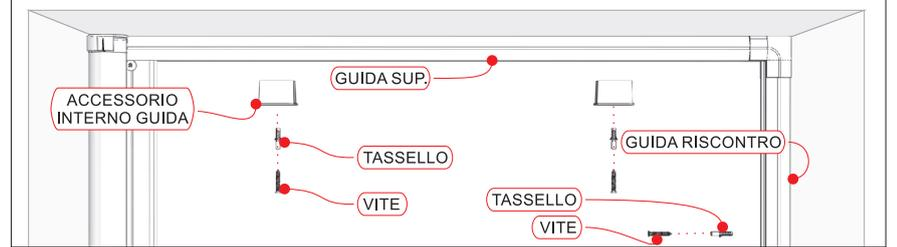
**6** Fissare la guida di riscontro, al centro e nella parte bassa, e inserire la guida inferiore nella cerniera.
